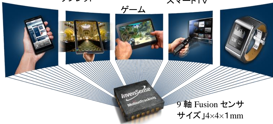
図6 9軸 Fusion センサの応用例(3軸 MEMS ジャイロ+3軸電子コンパス+3軸加速度)
